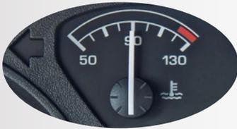
**Nota:** Recordemos que la temperatura óptima de funcionamiento de un motor es entre los 90°C y 100°C
